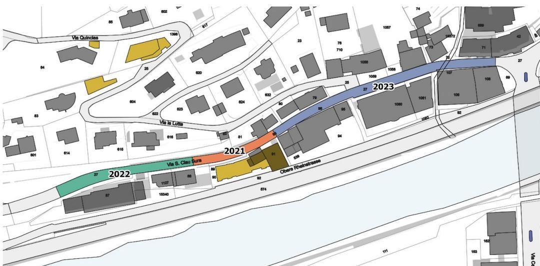
Pro Etappe sollen je nach Strassenbreite eine Vollsperrung oder eine Teilsperrung erfolgen. Nach dem Aufbruch erfolgt der Werkleitungersatz mit Trinkwasserleitung, Fernwärme, Strassenentwässerung und Stromleitung. Anschliessend erfolgt nach der Rohrumhüllung der Einbau der Foundationsschicht und der Tragschicht. Der Deckbelag wird jeweils nach einer Wartefrist von rund einem Jahr eingebaut.
